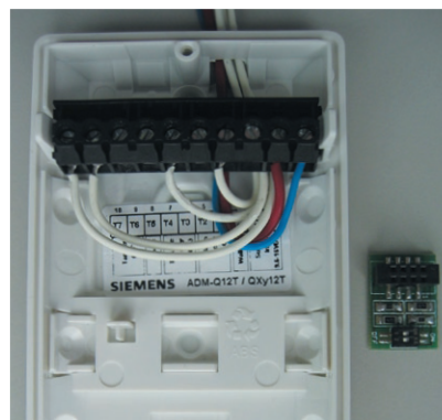
Jednoduchá volba hodnoty rezistoru s deskou EoL
